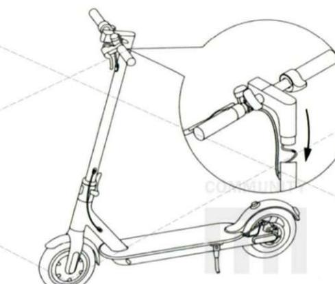
3) Закрепите ручки в рулевой стойке с двух сторон, с помощью 4-х болтов и ключа, которые идут в комплекте;
