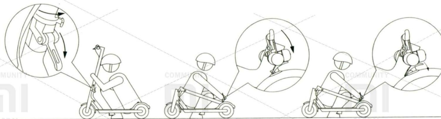
Убедитесь, что электросамокат выключен. Ослабьте фиксирующий рычаг и опустите рулевую стойку. Переведите рулевую стойку в горизонтальное положение и закрепите ее, вставив крючок в специальное кольцо, которое находится на заднем крыле. Чтобы собрать электросамокат, отсоедините рулевую стойку от крыла, переведите ее в вертикальное положение и зафиксируйте с помощью рычага.
