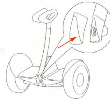
3 Установите защитную крышку (характерный щелчок указывает на успешную установку крышки)
