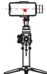
**⚠️ Правильная балансировка устройства позволит снизить энергозатраты во время его работы. Стабилизатор способен функционировать в режиме, когда центр тяжести не сбалансирован должным образом, но это приведет к значительному расходу энергии моторами, а также может повлиять на КПД крутящего момента.**
